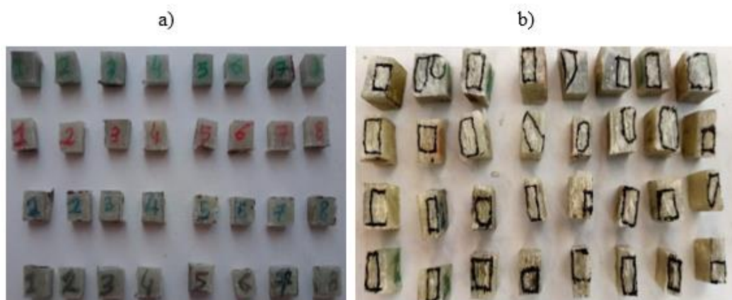
Şəkil 4. Sıxılma sınaqları üçün hazırlanmış PKM nümunələri: a – sınaqdan əvvəl; b - sınaqdan sonra
