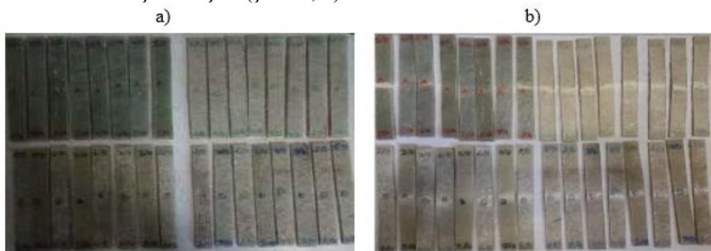
Şəkil 6. Üç nöqtəli əyilmə üçün PKM-in sınaqdan keçirilməsi üçün hazırlanmış nümunələr: a – sınaqdan əvvəl; b – sınaqdan sonra
