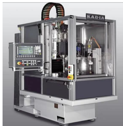
Şəkil 1. Müasir rəqəmli-proqramla idarə olunan honlama dəzgahları:
