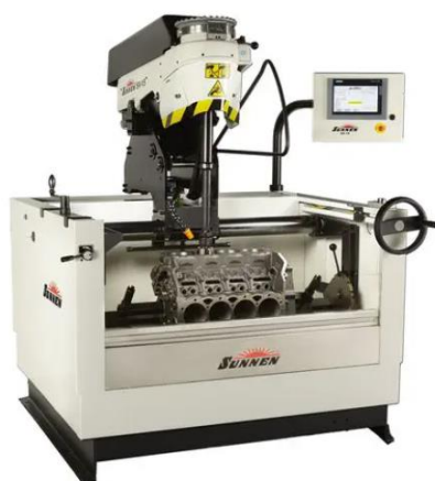
Şəkil 1. Müasir rəqəmli-proqramla idarə olunan honlama dəzgahları:
