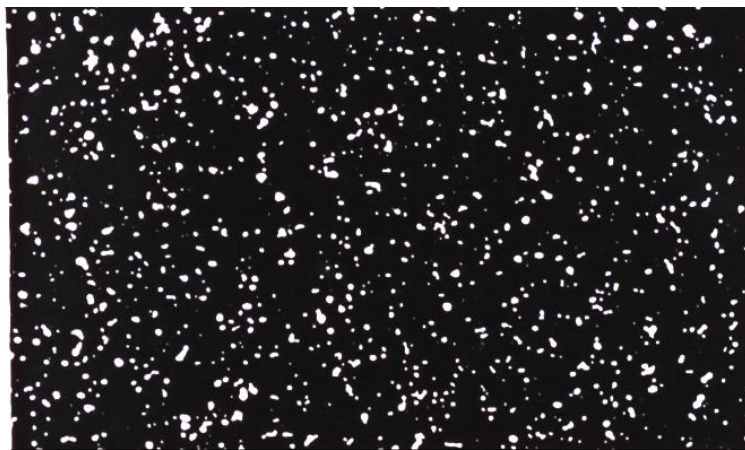
Рис. 4. Микроструктура порошковых заготовок после горячей пластической деформации: X500
