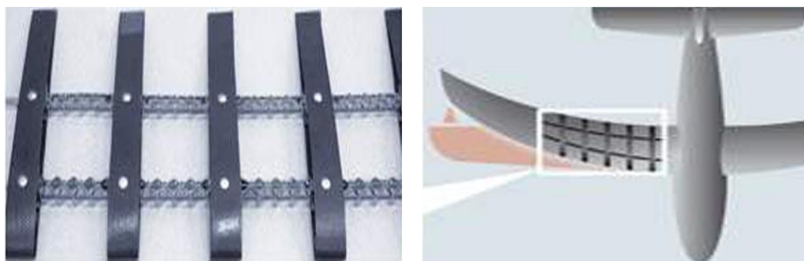
Şəkil 3. Formayaddaşlı materialdan PUA-nın qanadının əyilməsi:
