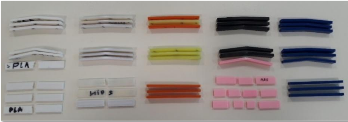
Şəkil 2. Əyilmə sınaqlarından sonra nümunələr: - yuxarıdan aşağıya: +22°C, 0°C, -40°C-də; - soldan sağa: PLA, HIPS, SBS, ABS, PETG
